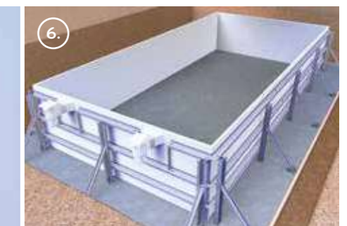
6. Installer les éléments enterrés (skimmer, refoulement)
