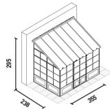
Serre avec couverture en polycarbonate, 1 fenêtre et 1 porte avec panneaux latéraux en polycarbonate
