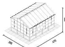
Serre avec couverture en polycarbonate, 1 fenêtre et 1 porte avec panneaux latéraux en polycarbonate
