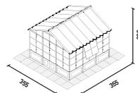
Serre avec couverture en polycarbonate, 1 fenêtre et 1 porte avec panneaux latéraux en polycarbonate
