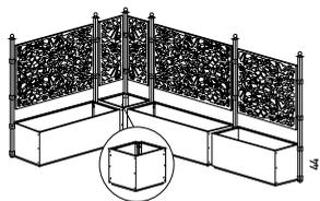
Tous les panneaux Caprice doivent être montés entre 2 piliers à une distance dépassant de 8,5 cm la mesure du panneau et fixés avec le kit Réf. EFP4B ou Réf. EFP4. Pour fixer les jardinières Caprice aux piliers utiliser 4 joints Prestige en aluminium Réf. G55NCB (blanc) ou Réf. G55NCB (graphite) qui rendent compatibles les jardinières de longueur de 37, 109, 157, 181 cm avec les treillages de 30, 102, 150, 174 cm. Un élément d'angle de 42 x 42 cm est disponible.
