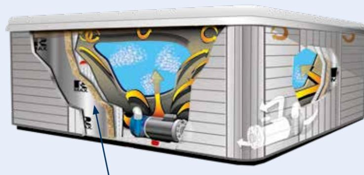
Panneau d'isolation thermique RMAX-3 en mousse rigide de type STYRODUR, d'épaisseur 40 mm, composé de matériaux écologiques.
