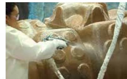
Projection de la résine vinyloxy et de la fibre de verre
