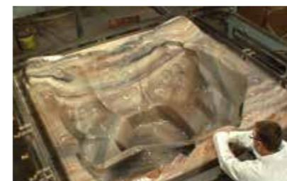
Thermoformage de la coque
