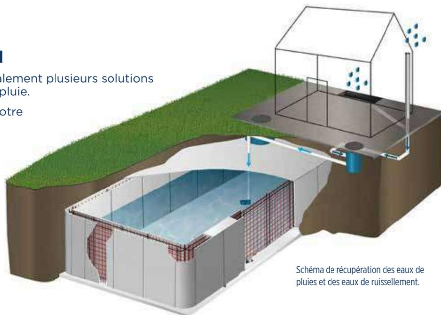
Schéma de récupération des eaux de pluies et des eaux de ruissellement.
