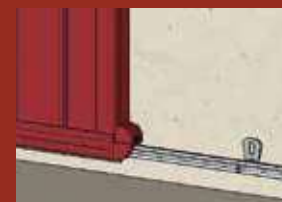
Réglette support en partie basse pour porte-fenêtre
